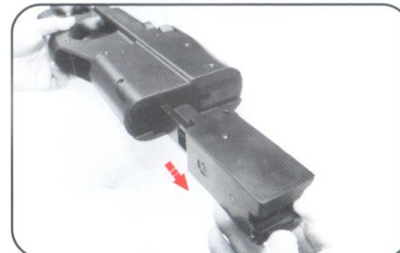
再將整個扳機組件取出
